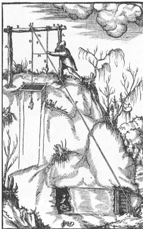
FIGUR 2. Uppmätning av ett schakts djup genom triangulering med ett rep. Ur: Georg Agricola, Vom Bergwerck XII Bücher . Basel 1557.
