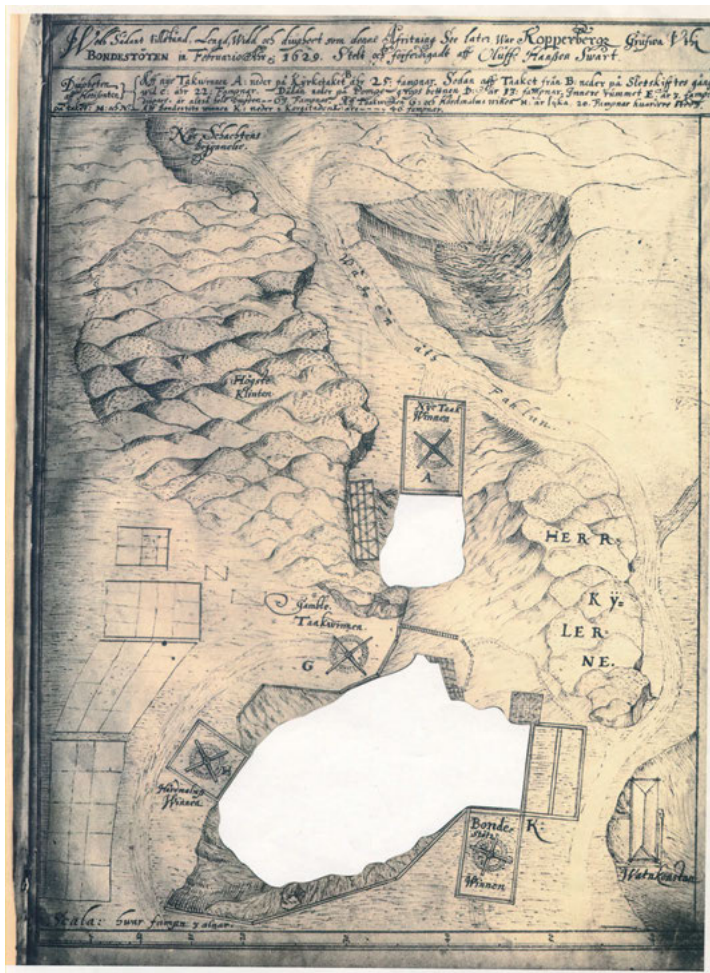
FIGUR 6. Kopperberget Grufwa Uthi Bondestöten i Formario Åhr 1629. Stelt och förferdigadt aff Oluff Hansson Swart. Bergslagens arkiv, Falun. Swart (senare adlad Örnebufvud) har här återgett dagbladet till Bondestöten i Stora Kopparbergs gruva. Vid A öppning till Pumpegropen, stora hålet visar den vidlyftiga Bondestöten öppen ner till 46 famnars djup; t.h. Bondestötskonsten. Längst upp t.v. plats för gruvans första schakt.
